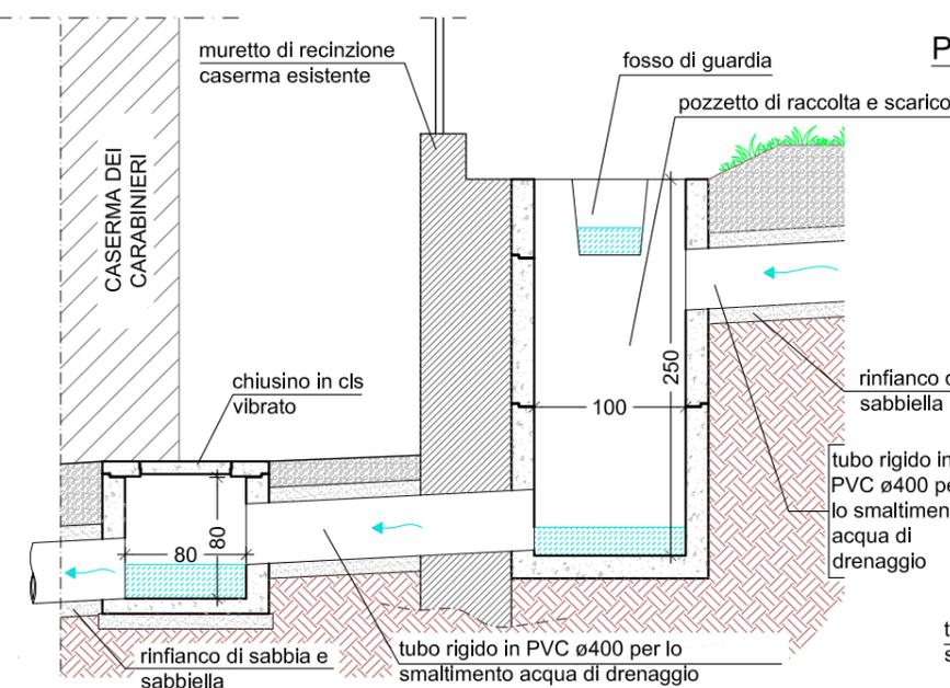
**POSA IN OPERA TUBO PER LO SCARICO ACQUA DI DRENAGGIO**
